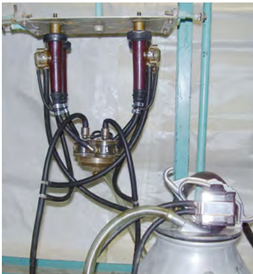
Рисунок 2. Опытный образец доильного аппарата с однокамерными стаканами
